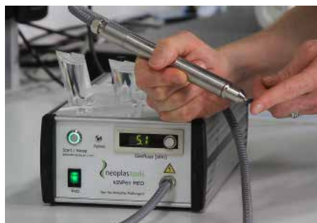
Abb. 2: Beispiel für eine typische Plasmajet-Quelle ist der kINPen MED®.
